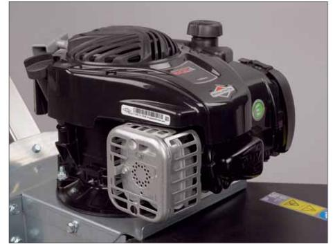
Zum Antrieb der Bürste dient ein solider Briggs & Stratton-500-E-Motor mit 140 cm<sup>3</sup>
